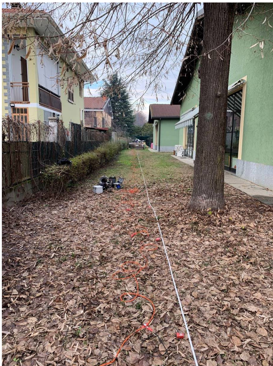
Foto 4 – L'esecuzione della prova sismica MASW
